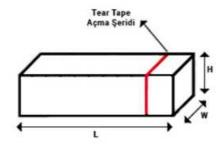
Height (H) : Min 10 mm - Max 80 mm OPP Lenght : Min 150 mm - Max 420 mm
